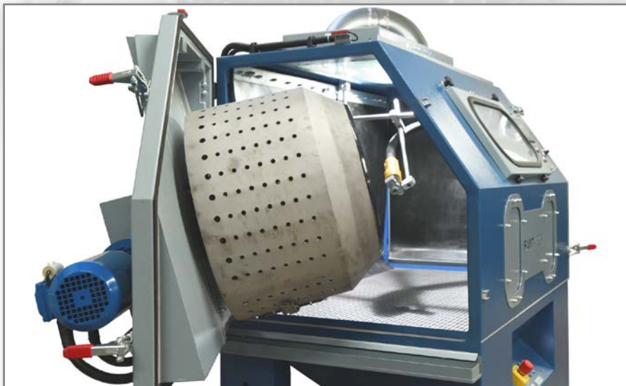
Поворотный барабан для обработки мелких элементов.
