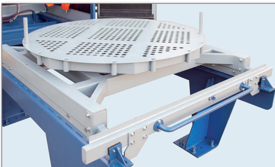
Поворотный стол с адаптированной грузоподъемностью в соответствии с требованиями клиента, выдвигается на боковой тележке, что облегчает загрузку и выгрузку деталей.
