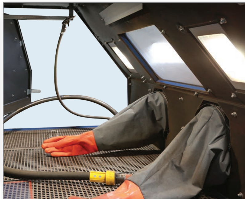
Боковые отверстия для обработки длинных деталей.
