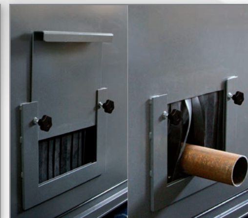
Боковые отверстия для обработки длинных деталей.
